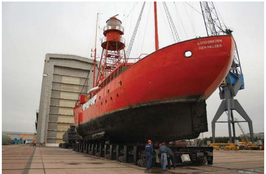
Voor inspectie en onderhoud van het onderwaterschip staat het lichtschip droog bij het Marinebedrijf Foto Stichting Historie der Kustverlichting
